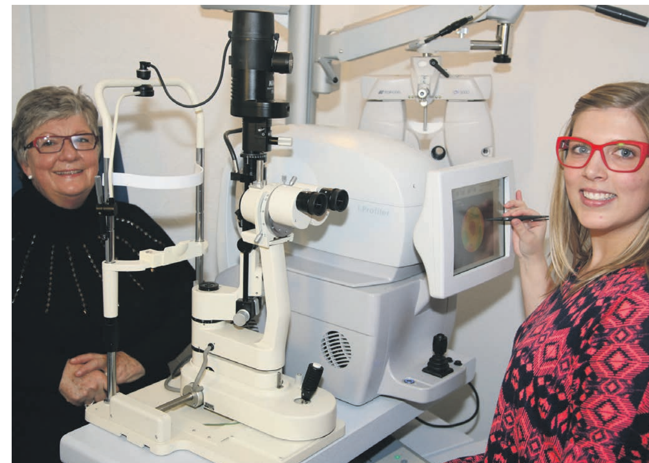
Optikerstuderende Louise Gadkjær fra Nyt Syn i Randers har her Merete Schønnemann i Zeiss i Profiler-apparatet, der bruger 100.000 målepunkter til at lave en nøjagtig synsprofil af hvert øje. Synsprofilen er en slags optisk landkort over dine øjne. Selv de mindste afvigelser fra øjets idealform måles elektronisk og gøres synlige.
